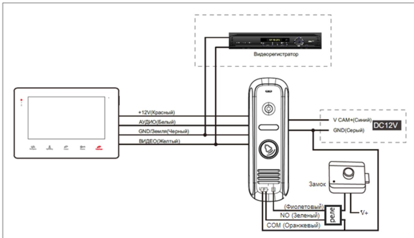
Если камера в панели используется в постоянном режиме (например, для записи на регистратор), то необходимо объединить Синий и Красный провод.
